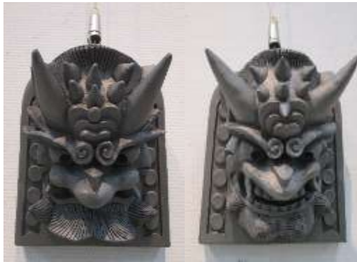
「鬼瓦」ガス窯 ・サイズ七寸の鬼瓦(阿)(呷) ・富岡鬼瓦工房にて焼成(24時間かけ 1080℃焼成) (950℃より 30 分間燻し焼することで炭素膜が付着) ・自分のオリジナルなので髭など自分なりに作りました。
